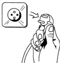
Figur 3. Före rengöring av värmeväxlare och fläktar etc skall aggregatet alltid göras spänningslöst. Dra ut stickkontakten.
