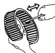
Figur 9. Fläkthjulets kåpa och fläktvingar rengörs med en borste. OBS! Skada inte några av balansvikter i fläkthjulet och se även till att inga kablar fastnar under återmonteringen.
