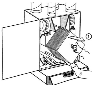
Figur 5. Värmeväxlaren tas ut ur aggregatet. Vid återmontage kontrollera att tätningarna sitter rätt.
